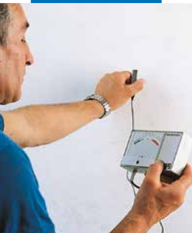
Feuchtemessung des Putzuntergrundes
