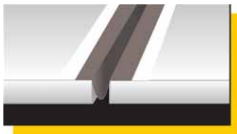
Schlaufenförmige Ausbildung von Mapeband PE 120 im Dehnfugenbereich
